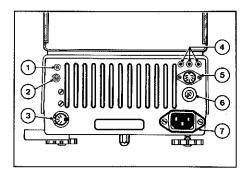
Bedienelemente und Anschlüsse an der Rückseite der Waage:
